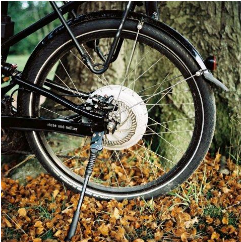
Der getriebelose BionX-Motor im Hinterrad (250 Watt) arbeitet völlig lautlos.
