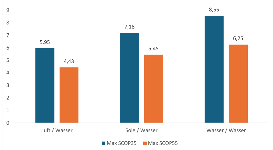
Abbildung 34: Seasonal Coefficient of Performance aktueller Wärmepumpensysteme
